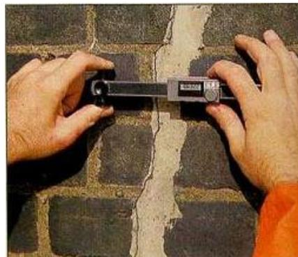
Figura 3. Medición de grietas con el equipo Crack Measuring Gauge.
