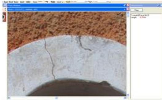
Figura 2: Dimensión longitud de la grieta seleccionada.
