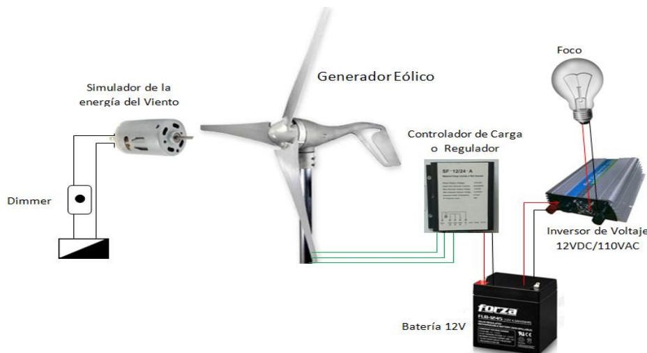
Figura: Esquema Gráfico del Montaje de los elementos que componen el Simulador Eólico
